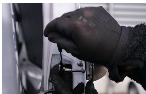
F. Skruva fast låset från dörrens insida
